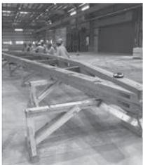
第一工区で一番大きなA棟の屋根を支える張弦梁の仮組検査の様子です。
