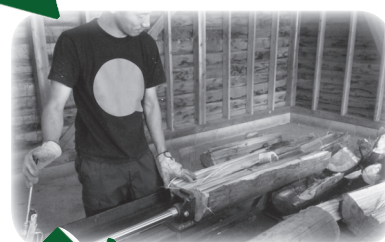
薪割り機で割る
