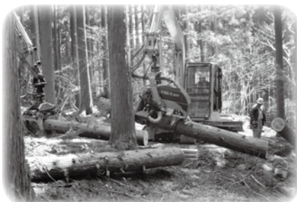
立木の伐倒・枝払い・玉切りした木材を集めて積み込みます。
