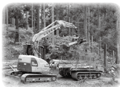
玉切った木材をフォワダへ積み込み山土場へ持って行きます。
