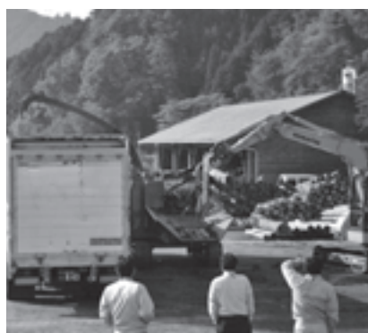
写真3 残材を掴み、ウッドハッカーへ。ウッドハッカーからトレーラーへ。
