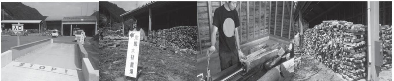
車ごと計量器へ → 林地残材は指定の場所へ → 薪割り機で半割に → 積み上げて乾燥
